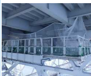
点検補修用桁内面作業車
