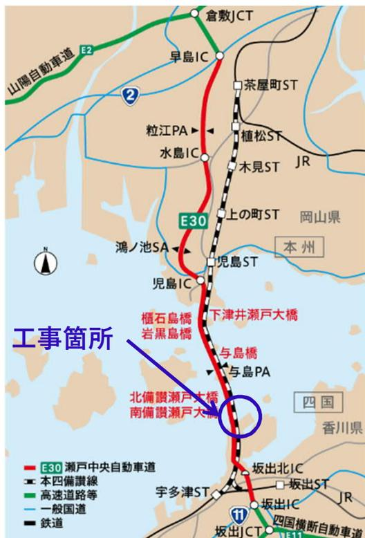
一般国道30号（瀬戸中央自動車道）の南備讃瀬戸大橋において、鋼床版伸縮装置取付ボルトの取替を実施したものの。
