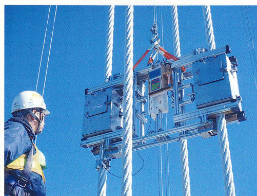
吊橋ハンガーロープの計測例
